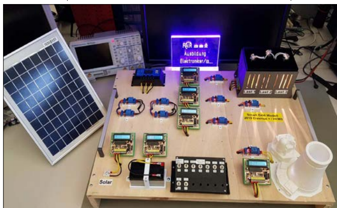
Praxismodell „Smart Grid“ zur Simulation von Netzszenarien
