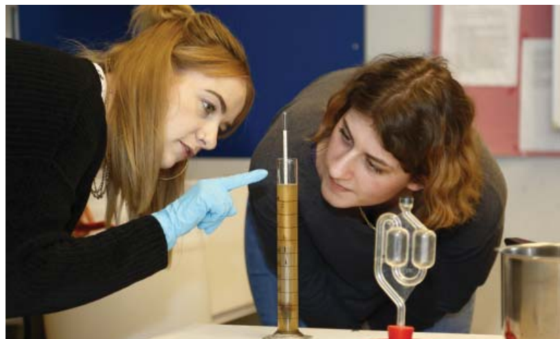
Links Christina Clobes, rechts Felicitas Richter bei der Messung des Zuckergehalts mittels eines Aräometers
